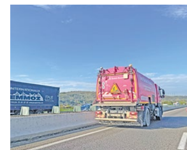
Pour déterminer quelle portion d'autoroute doit faire l'objet de travaux, la SANEF fait passer deux camions avec des systèmes de mesure pour contrôler les fissures par exemple.
